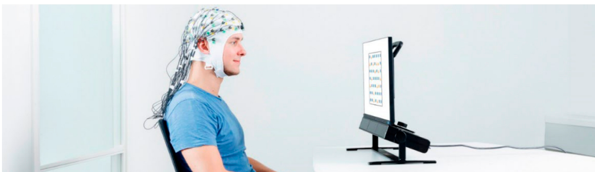
Figuur: Een deelnemer die een computer uitgerust met een oogtracker samen met elektro-encefalografische (EEG) apparatuur gebruikt. (Met dank aan Tobii Technology.)
